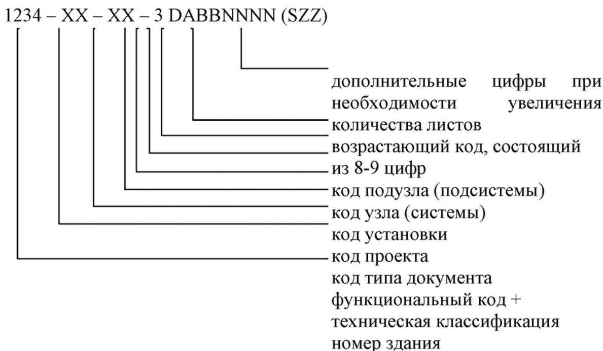
Рис. 1. Пример расшифровки нумерации чертежа
